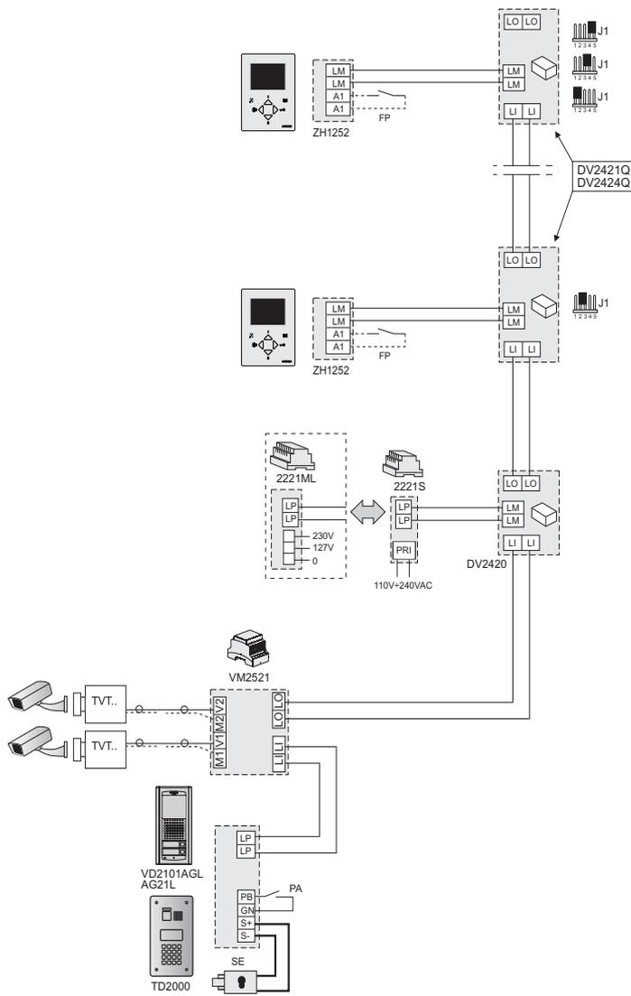
Collegamento con il distributore di montanti DM2421.
